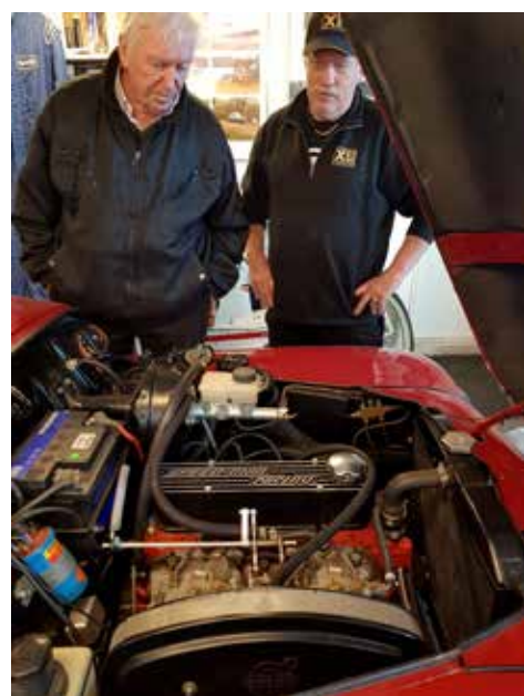
Mats Thelander och Tomas diskuterar motorn i en PV Sport utrustad med en Speedman Racing motor med dubbla Weber 45-or
