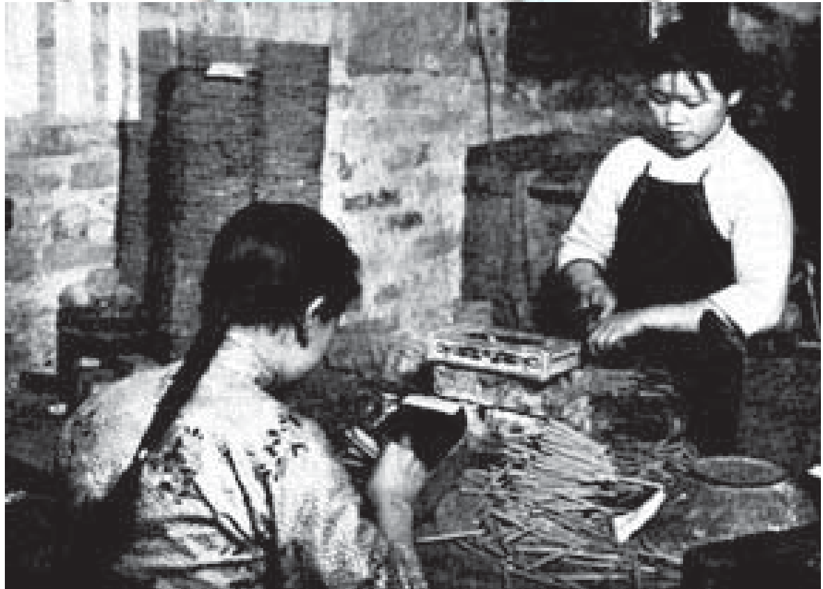
ယမ်းရောစပ်ပြီး မီးကျည်မီးပန်းများတွင် ယမ်းဆံတပ်ပေးနေကြပုံ
