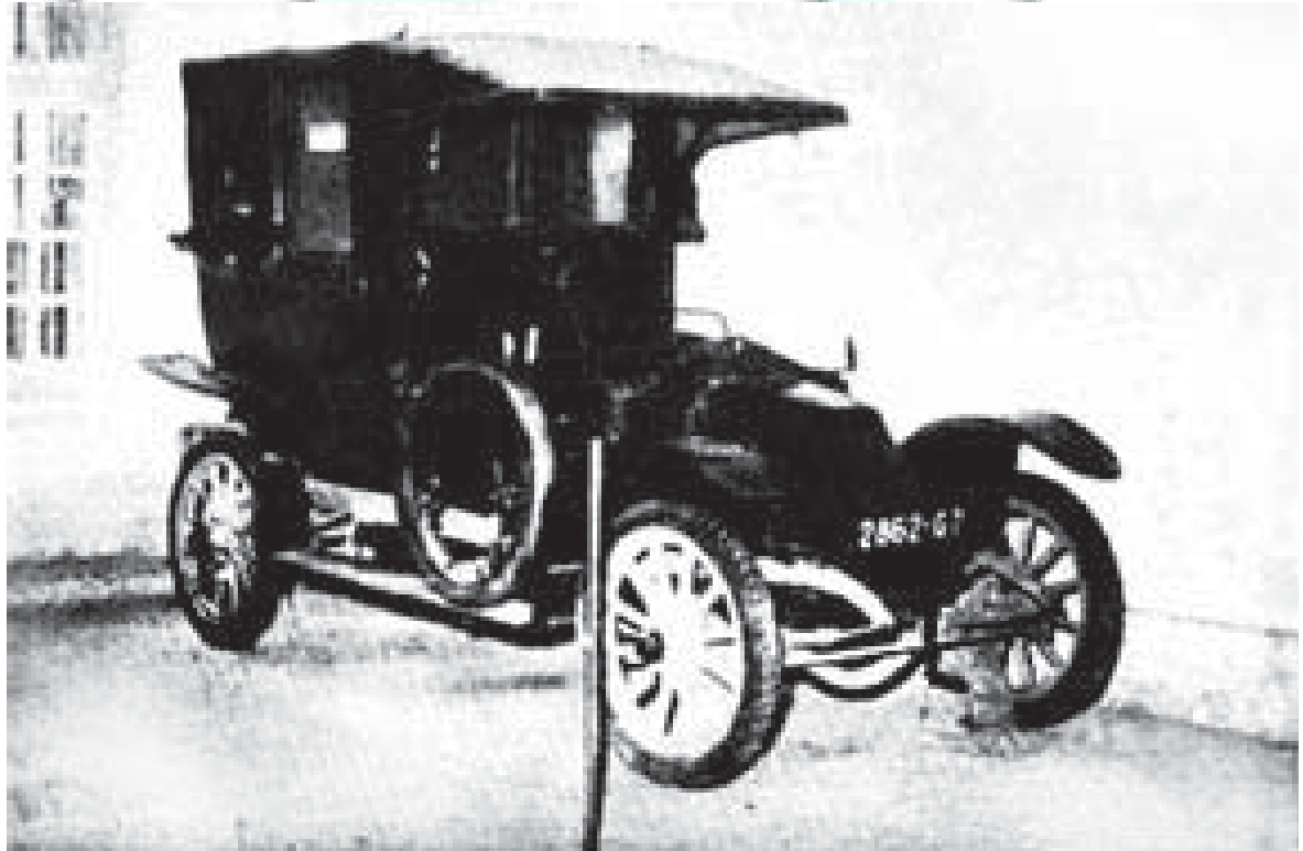
၂၀ ရာစုဆန်းစက တီထွင်အသုံးပြုခဲ့သော မော်တော်ယာဉ်ဖြစ်သည်။ ထိုခေတ်က မော်တော်ယာဉ်ပုံစံမှာ မြင်းရထားပုံမျိုးဖြစ်၍ စက်နှိုးလိုသော် လက်လှည့်ကောက်တံဖြင့် လှည့်နှိုးရသည်။
