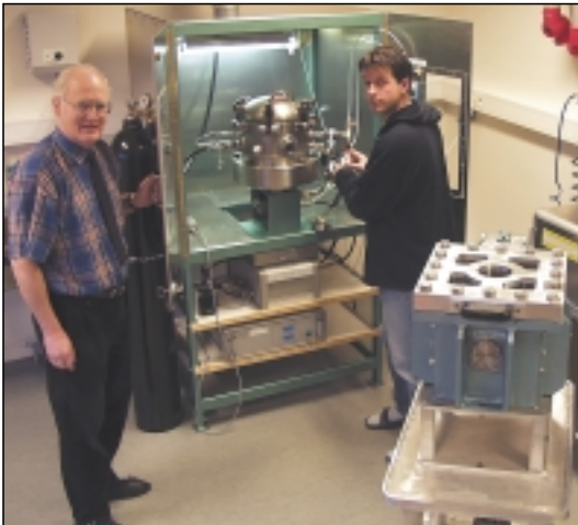
Professor Rolf K. Eckhoff ved Fysisk institutt og hovedfagsstudent Trygve Skjold foran lukkede ekspløsjonskamre. Her gjøres det forsøk med gass- og støvekspløsjoner.
