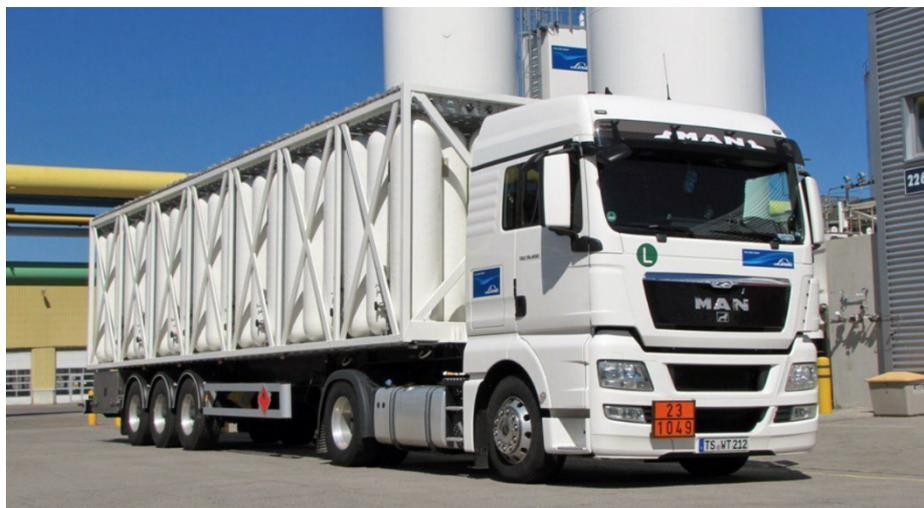
Wasserstofftransport mit 500-bar-Wasserstofftrailer. Bild: Linde
