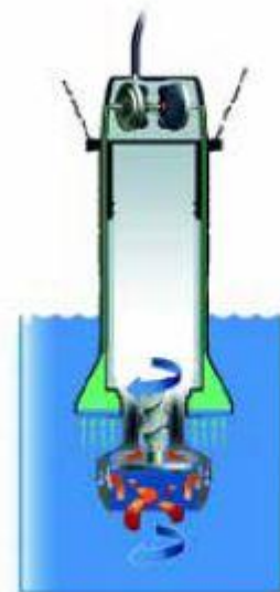
LPS pumpen lager kraftig rotasjon på vannet for å hindre sedimentering
