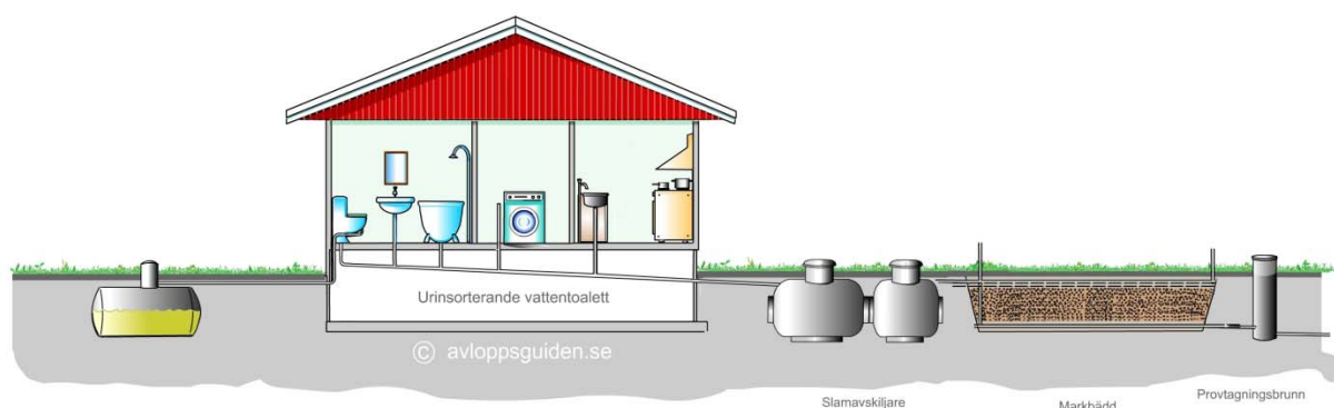
Figur 9. Urinsortande avloppssystem med våt fekaliehantering. Fekalierna leds alltså tillsammans med BDT-vattnet till en gemensam behandling, antingen i reningsverk eller i en enskild anläggning. Figuren visar en enskild anläggning där fekalierna, tillsammans med BDT-vattnet behandlas i slamavskiljare och markbädd. Figuren är från Avloppsguiden med tillstånd.
