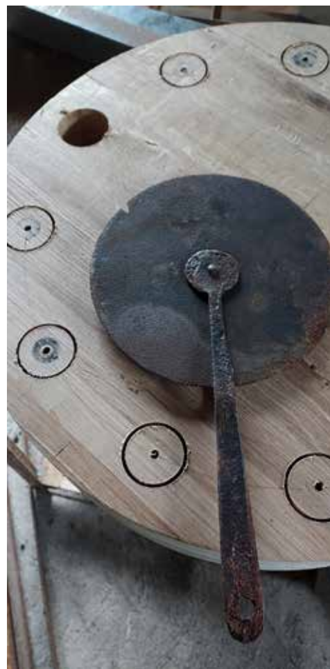
Møllehjulet til Klostermølle under fremstilling og smedjens "hjulmål"
