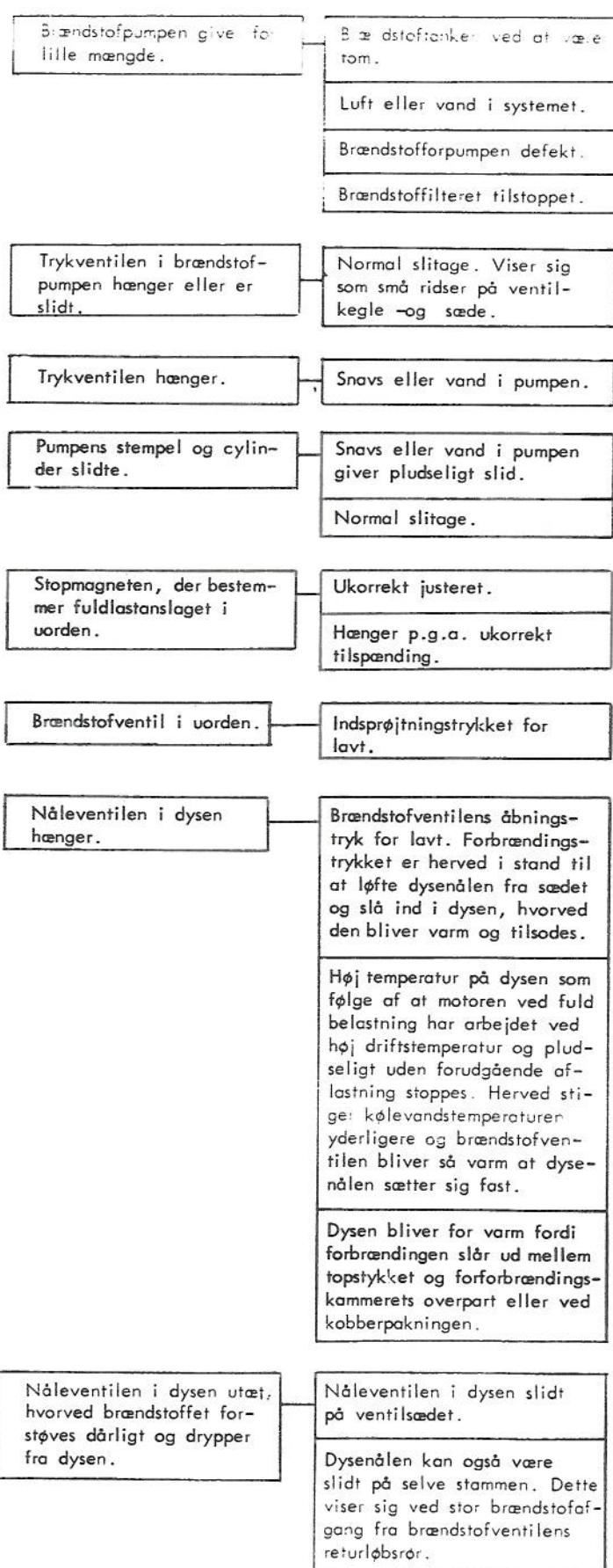
2. MOTOREN STOPPER KORT EFTER START.
