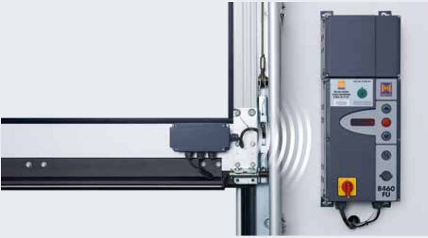
Trådløs overføringsenhet Ekstrautstyr for signaloverføring fra portbladet via Bluetooth til styringen – i stedet for en spiralledning. Strømforsyningen skjer via et kraftig batteri. Komponenter som kan tilkobles: Optosensorer LE (lavenergi), underliggende fotocelle VL 1/2-LE, 8k2-list, wireslakk-bryter, gangdørkontakt, kontakt for nattlås
