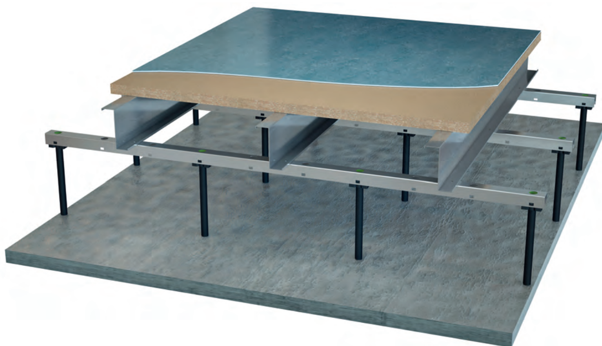
7000N hög höjd med Z-profil av stål + 38 mm spånksiva + matta
