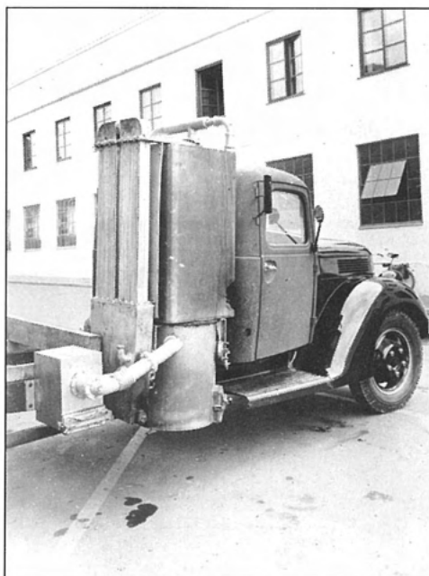
I samband med krigsutbrottet kom gengastillverkningen. Professor Svedlunds patent låg till grund för det första gengasaggregatet, som gjordes 1939.
