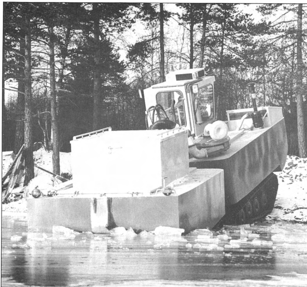
Kalkningsmaskinen var byggd på bandvagnens chassie, bandaggregat och dieselmotor-transmission och togs fram i samarbete med Firma Caspor i Finland.
