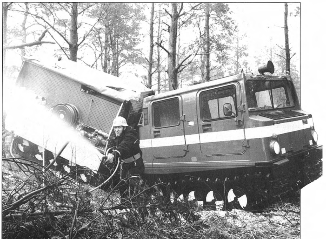
I civilt bruk har bandvagnen visat sig oöverträffad. Med hjälp av olika moduler kan den användas som brandbandvagn, terrängambulans m m.
