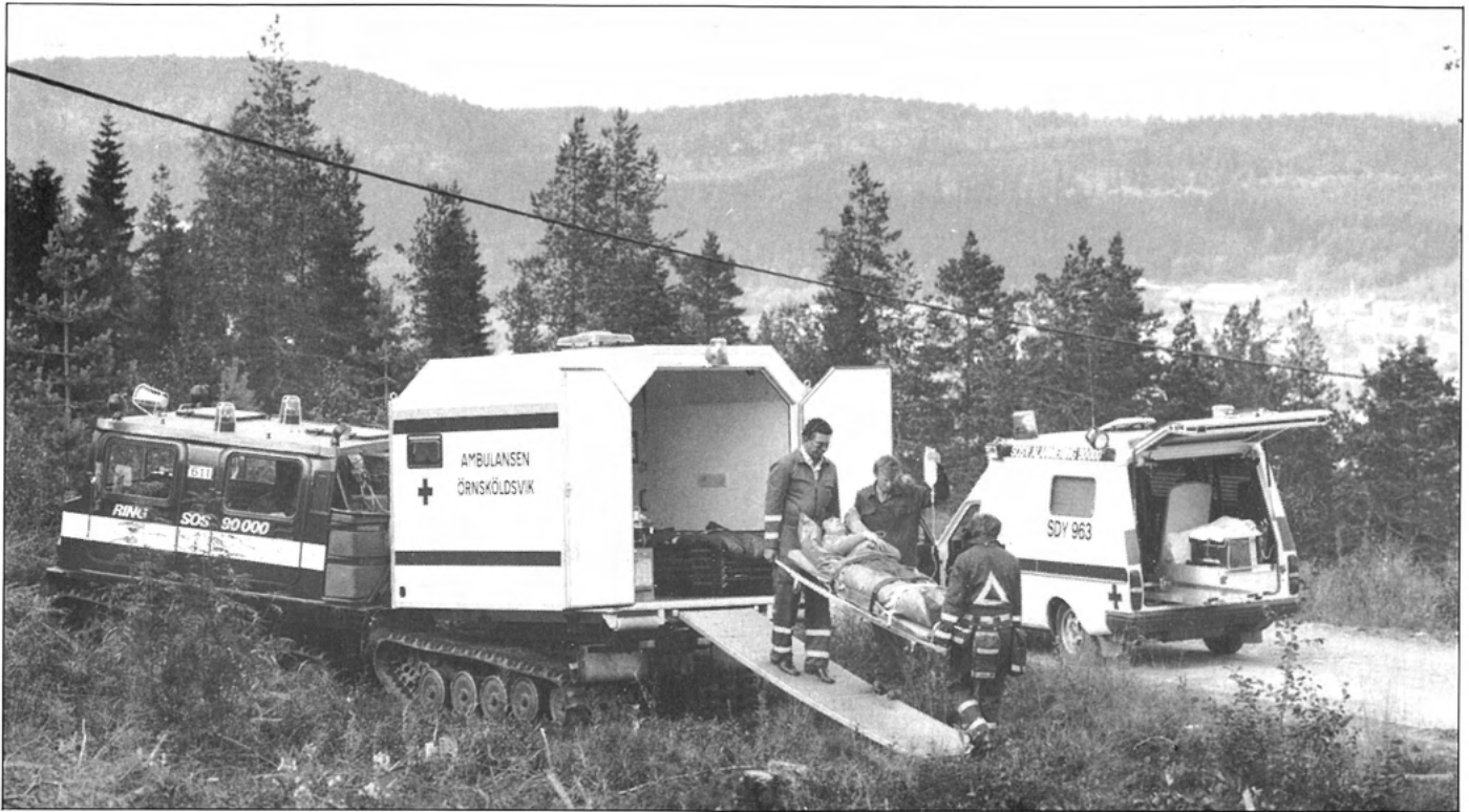
I civilt bruk har bandvagnen visat sig oöverträffad. Med hjälp av olika moduler kan den användas som brandbandvagn, terrängambulans m m.
