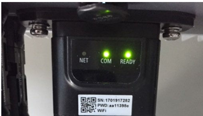
Figura 101 - Stato iniziale dei LED
