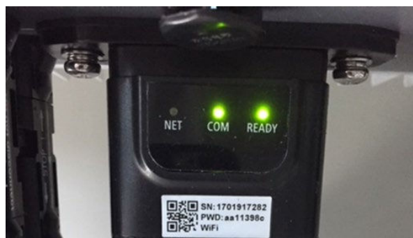
Figura 107 - Stato iniziale dei LED
