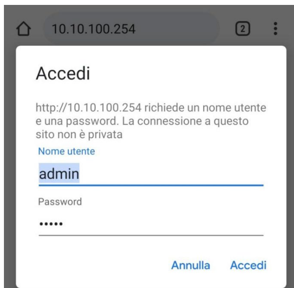
Figura 81 – Schermata di accesso al server Web per configurare l'adattatore WiFi
