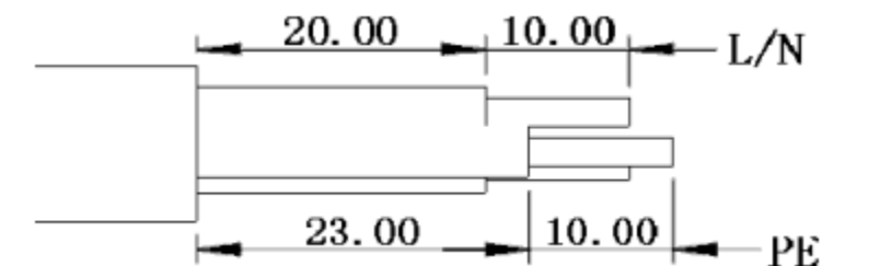
Figura 38 – Schema per la rimozione della guaina del cavo
