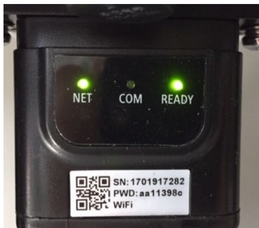
Figura 103 – Stato di comunicazione irregolare tra inverter e adattatore
