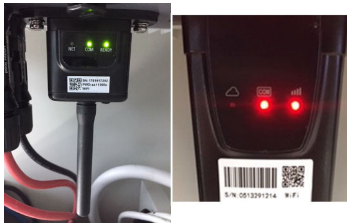
Figura 89 - Stato iniziale dei LED
