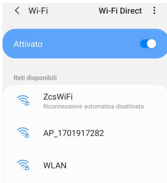
Figura 76 – Disabilitazione della riconnessione automatica a una rete
