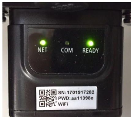
Figura 109 - Stato di comunicazione irregolare tra inverter e adattatore
