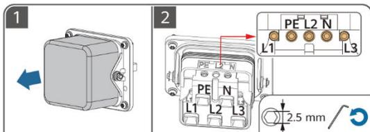
**NB** Koble til en AC-utgangskabel
