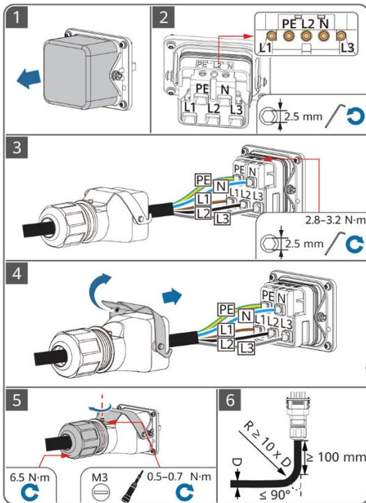
**BG** Свързване на AC изходящ
