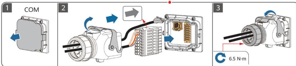
**BG** Свързване на сигнални кабели
