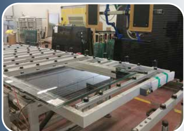
2 - Scarico dei Vetri Fotovoltaici
