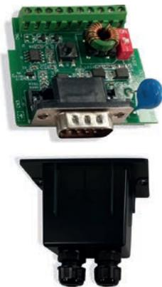
DB9 slot di espansione utilizzata per schede di comunicazione opzionali, ad esempio RS485.
