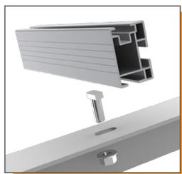
I profili 50 sono fissati orizzontalmente sulle strutture ad A.
