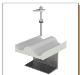
La vite prigioniere viene avvitata attraverso la lastra nella struttura del tetto. La rondella in EPDM garantisce il fissaggio a teanuta stagna.
