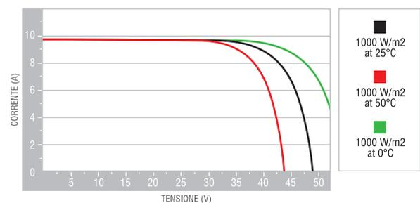
\*STC: (Standard Test Condition) Irraggiamento 1000W/m<sup>2</sup>, Temperatura Modulo 25°C, Massa d'aria 1.5
