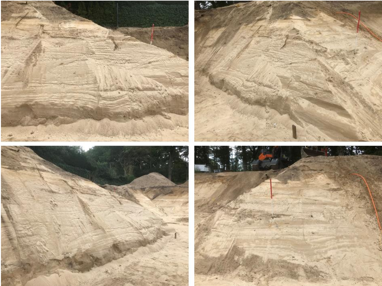
Afbeelding 88: Bouwput in Zeist; goed ontsloten noordoost wand met brede geulsystemen in horizontaal tot schief gelaagde zanden met summiere grindsnoeren.
