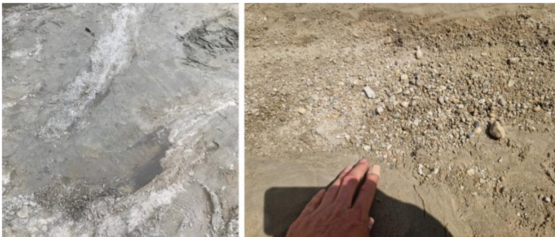
Afbeelding 8: Gecryoturbeerde grind- en zandlagen op de bodem van de bouwput, 4m - mv.
