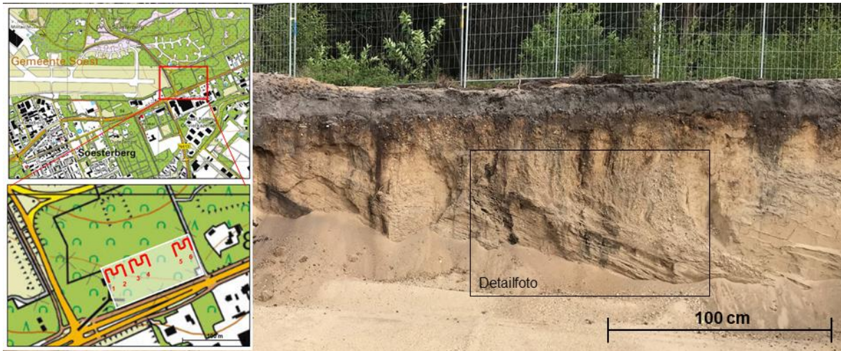
Afbeelding 65: Locatiekaart en profiel van scheefgestelde fluvioglaciale zand- en grindlagen in de Noordwand van bouwput 2. Overdekt met grindsnoer (~0.3m -mv), met daarboven dekzanden met daarin de restanten van een podsolbodem.
