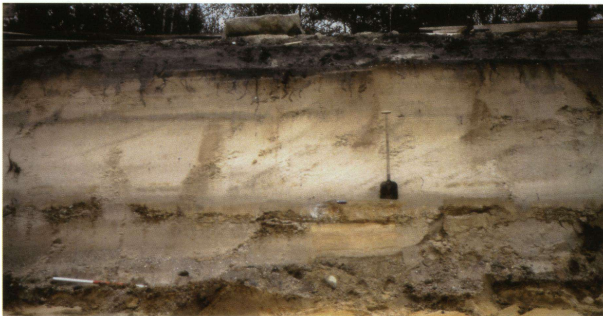
Afbeelding 18. Bekkenafzetting opgebouwd uit een afwisseling van klei- en zandlaagjes. Bouwput uitbreiding Wereldomroep. Zie afbeelding 1, pt. 10.
