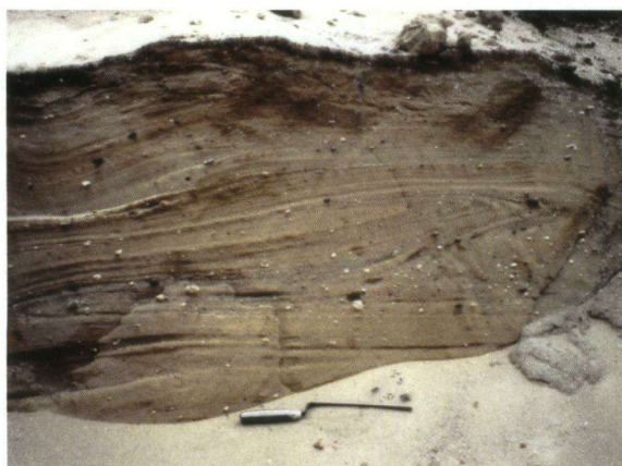
Afbeelding 13. Door vervloeiing gehomogeniseerd zand met grind in verspreide ligging ('krentenbroodstructuur'). Bouwput Gateway, Mediapark. Zie afbeelding 1, pt. 9.
