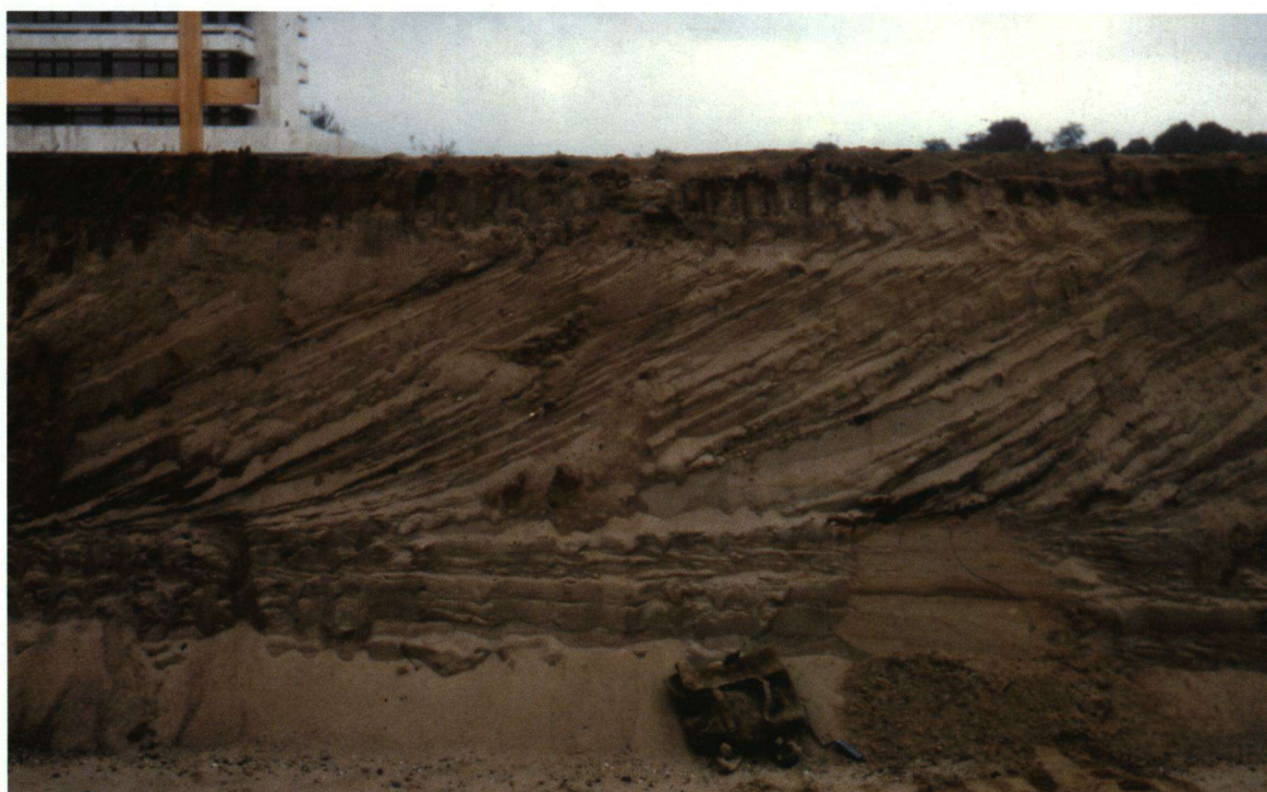
Afbeelding 14. Kryoturbate zone, bedekt door alluviale waaierafzettingen. Bouwput Videocentrum, Mediapark. Zie afbeelding 1, pt. 9.
