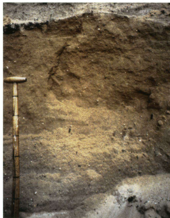
Afbeelding 13. Door vervloeiing gehomogeniseerd zand met grind in verspreide ligging ('krentenbroodstructuur'). Bouwput Gateway, Mediapark. Zie afbeelding 1, pt. 9.
