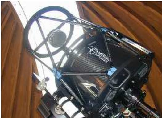
Abbildung 2: Der Reflektor hat einen Spiegeldurchmesser von 430mm, die Brennweite beträgt 2940mm, das Öffnungsverhältnis beträgt  $f/6,8$
