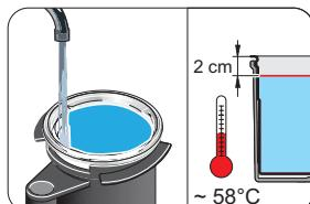
5. Fyll pacosseringsbehållaren (10) med **varmt** (ca 58 °C) vatten upp till ca 2 cm under behållarkanten.
