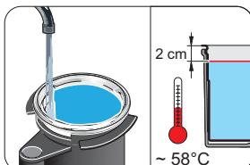
5. Fyld pacosseringsbægeret (10) med **varmt** (ca. 58 °C) vand til ca. 2 cm under bægerets overflade.
