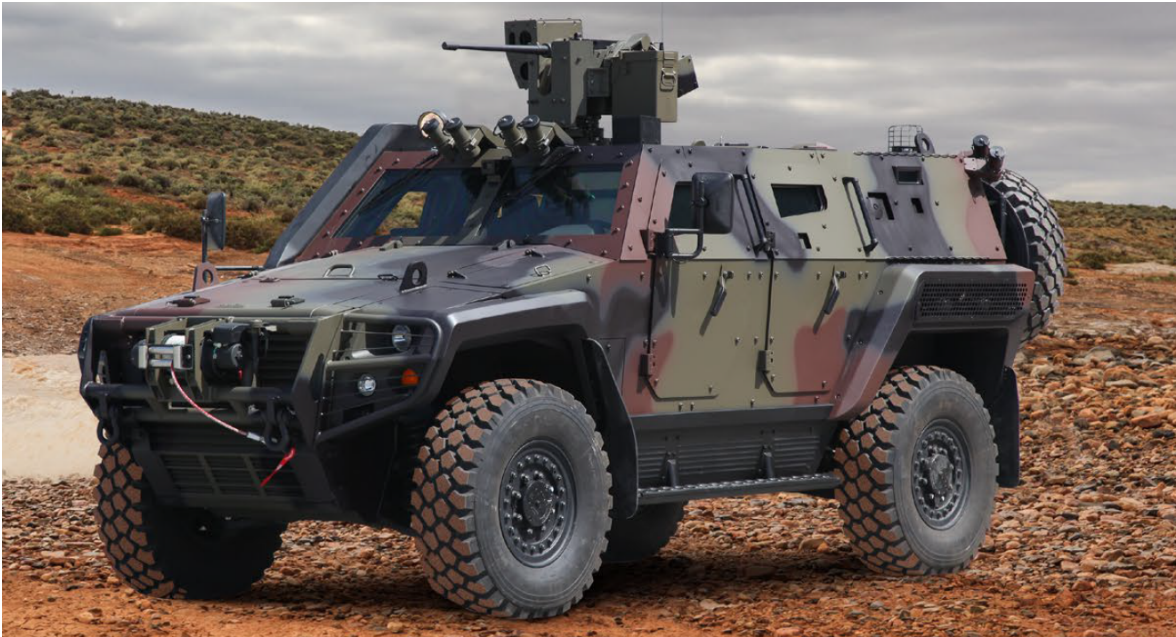
Panseret militærkøretøj Cobra II . Der kan monteres flere våbensystemer på køretøjet blandt andet Jord til luft-missiler, granatkastere og bemandede maskingeværer. Kilde: Otokar.com
