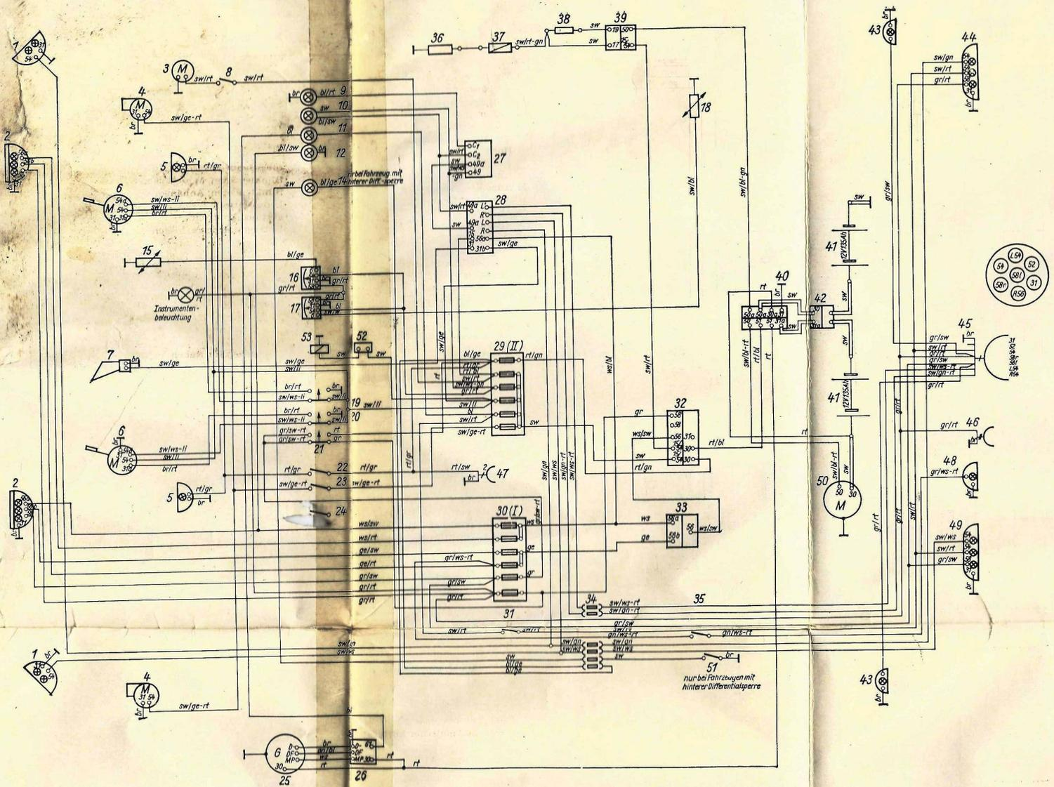
Bild 77. Elektrischer Schaltplan für W 50 LA/Z
