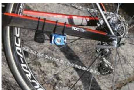
**Les transpondeurs devront être fixés sur la bicyclette** à une distance constante de la tangente de la roue avant. Ils ne pourront pas être portés par les athlètes.
