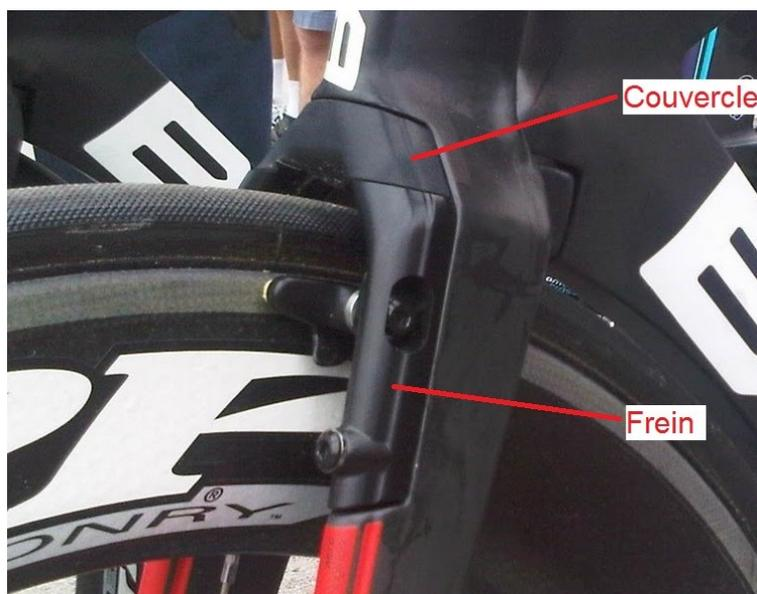
Figure 49 : Frein intégré à la fourche muni d'un couvercle
