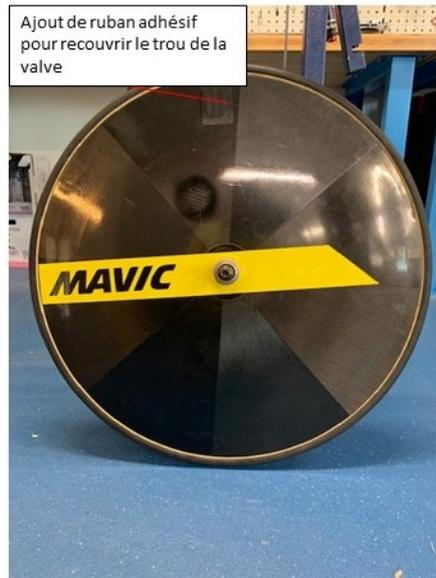
Figure 3 : Illustration de l'ajout de scotch appliqué sur une roue de contre-la-montre
