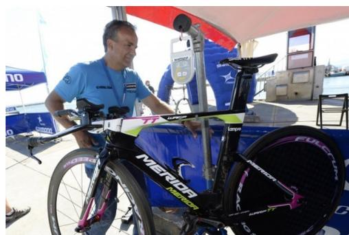
*Figure 9 : Mesure du poids d'une bicyclette*
