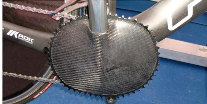
Figure 2 : Exemple de modification interdite avec l'ajout d'un couvercle en carbone sur les plateaux
