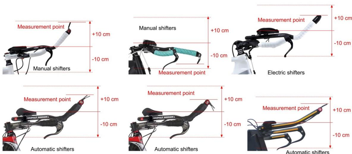
Figure 44 : Points de mesure des limites verticales des prolongateurs avec tous leurs accessoires
