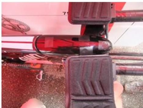
Figure 4 : Illustration de l'ajout de scotch pour couvrir l'accès aux vis
