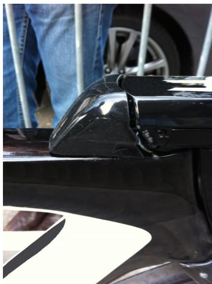
Figure 48 : Cache ajouté au cadre pour couvrir les câbles de frein
