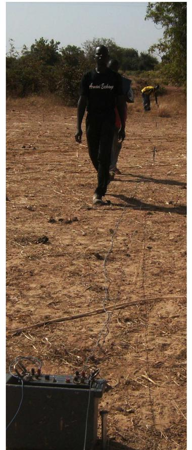
Durchführung einer geo-elektrischen Sondierung, um Aufschlüsse über Grundwasserbestände zu erhalten und den Brunnenstandort festzulegen.
