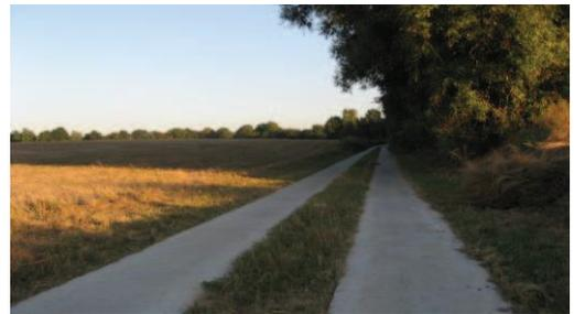
**L**e chemin en bi-bandes se compose de deux bandes de béton séparées par un bande de terre enherbée. Il possède la même résistance qu'un chemin de béton plein (même type de fondation) mais s'intègre mieux dans le paysage et réduit naturellement l'allure des voitures. Souhaitons que les accotements soient respectés pour laisser les plantes sauvages les recoloniser et reflleurir ! Vous trouverez plusieurs exemples de chemins en bi-bandes dans les villages d'Aineffe, Borlez et Les Waleffes.
