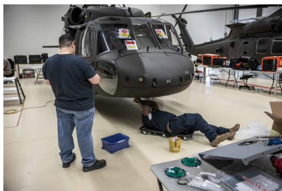
Pågående modifiering av Hkp16. Nu har samtliga Helikopter 16 i Försvarsmaktens modifierats för att öka räckvidden med cirka 50 procent. Foto: Jesper Moldvik
