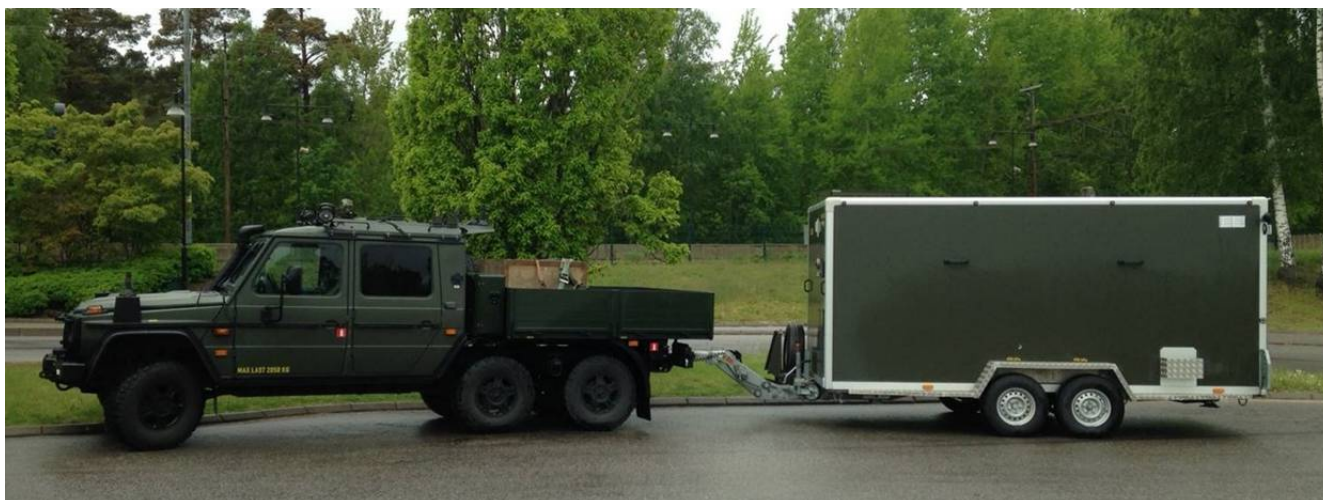
Flygvapnets nya klargöringsfordon, baserat på TGB15, kommer i en version för flygplan och en för helikoptrar. Foto: Conny Wennman
