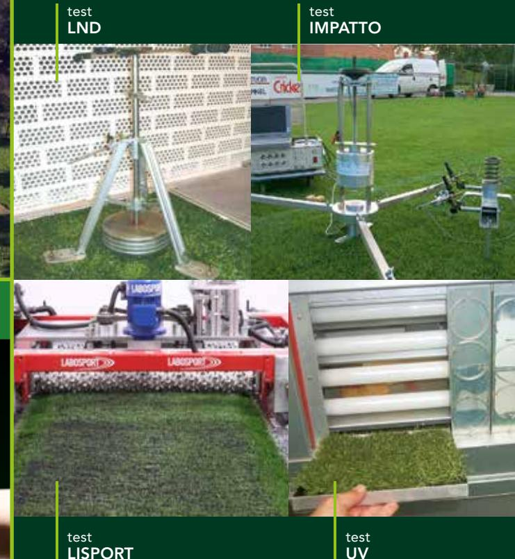
L'ultimo passo prima dell'installazione è testare i prodotti specifici; in questa fase Italgreen adatta e controlla la qualità del sistema di erba sintetica al fine di raggiungere la piena conformità con le federazioni italiane e straniere.
