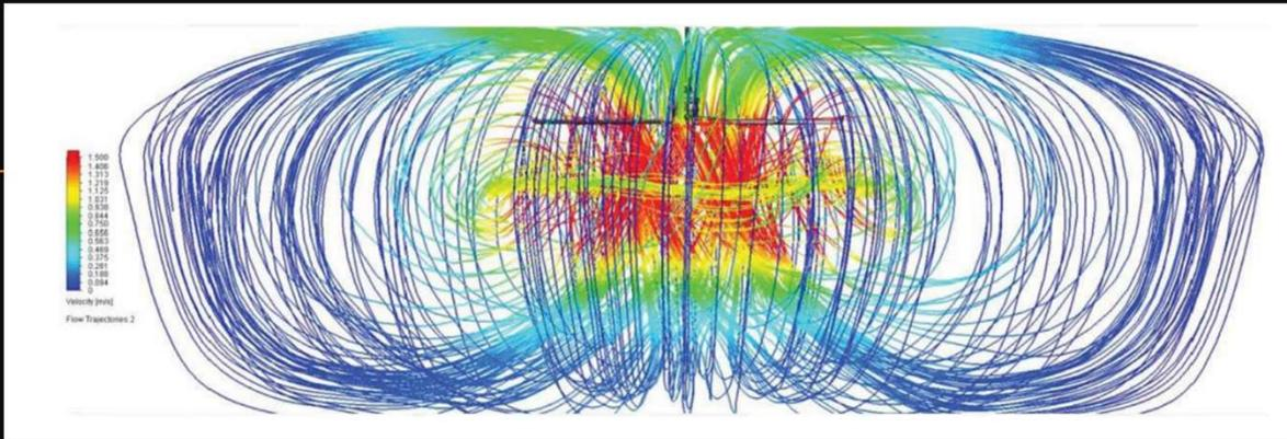
*Ruotando lentamente, a basso regime di giri, il mega ventilatore di EVEL crea un flusso d'aria le cui dimensioni raggiungono 4 volte il suo diametro...ed in tutte le direzioni, al contrario di un banale ventilatore assiale.*
