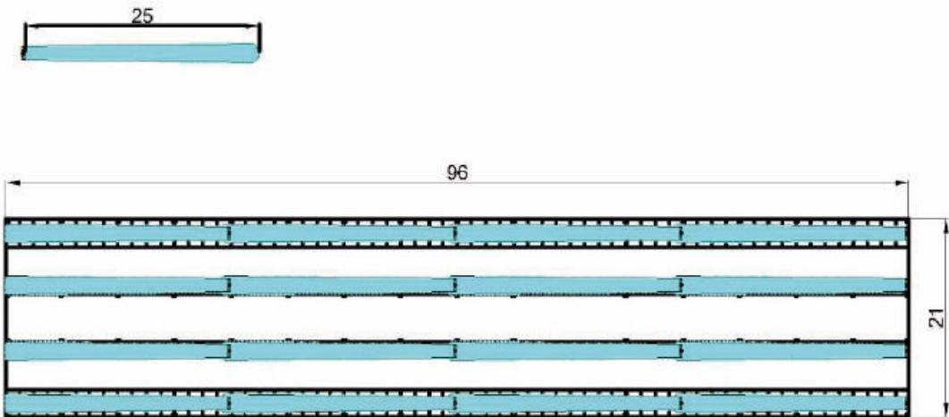
Con una gittata di lancio di 25 metri (velocità dell'aria 2,2 m/s) possiamo coprire il fienile con 4 ventilatori per corsia. (16 fan in totale)
