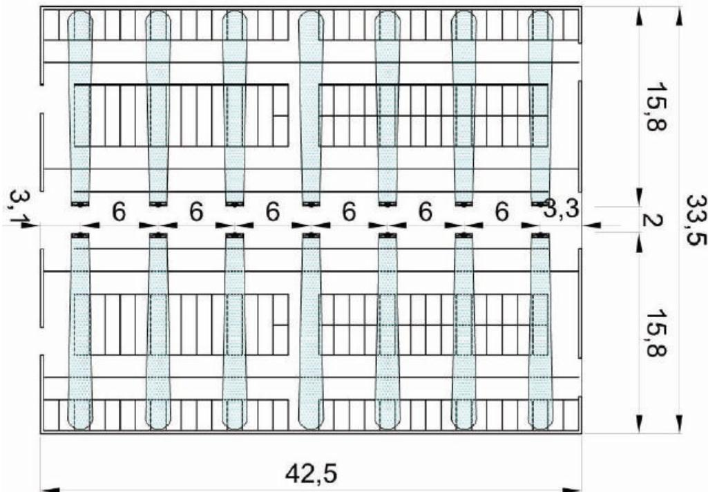
Direzione di ventilazione "inlet/outlet": realizzata da ogni modello di WA1400. In base alle dimensioni/layout della stalla possiamo scegliere il giusto modello WA1400 per ottimizzare l'installazione e garantire lo stesso comfort per tutto il bestiame.
