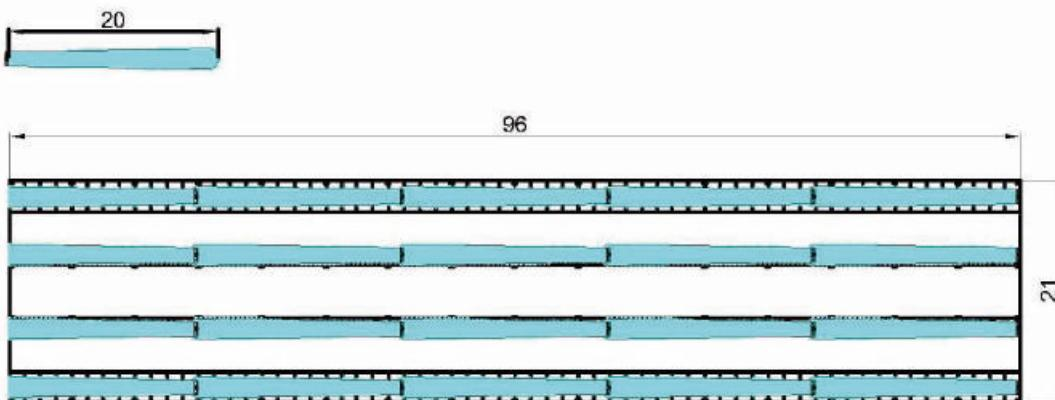
Con una gittata di 20 metri (velocità dell'aria 2,5 m/s) possiamo coprire il fienile con 5 ventilatori per corsia. (20 fan in totale)
