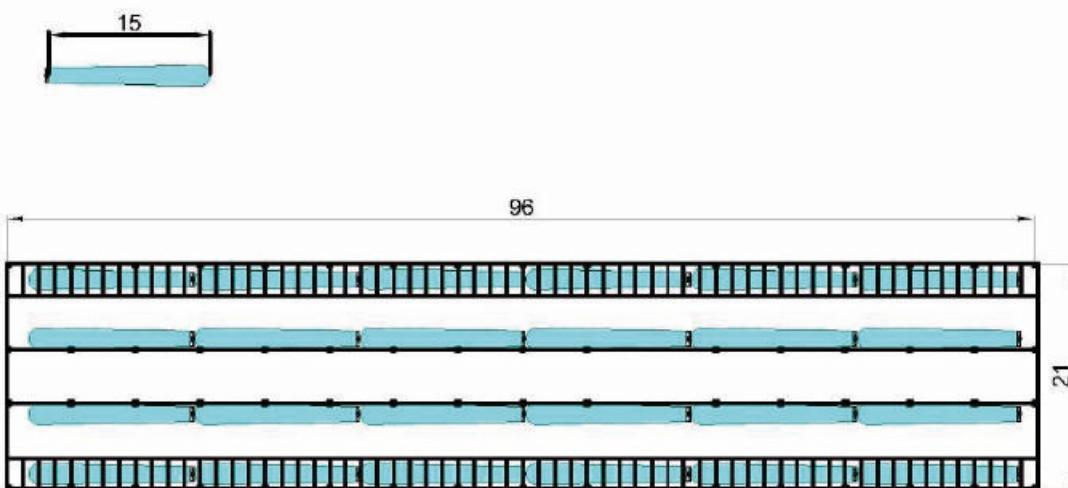
Con una gittata di 15 metri (velocità dell'aria 2,2 m/s) possiamo coprire il fienile con 6 ventilatori per corsia. (24 fan in totale)
