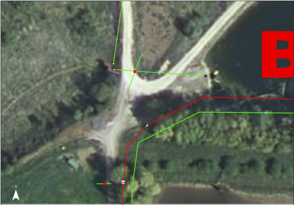
Les eaux du bassin canal B4 s'évacuent suivant deux moines, l'un donnant dans le B7, l'autre donnant dans le B2.
