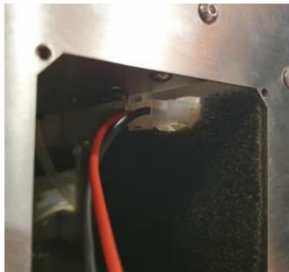
Figur 16 — Anslut batterikontakten till kontakten på brännaren.
