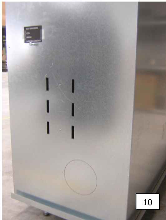
Perforerade konvektionshål för tillförel av rumsluft
