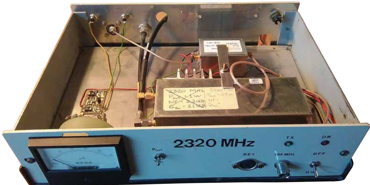
Billede 2: Min 13 cm transverter fik et nyt »liv« på 2.400 MHz.
