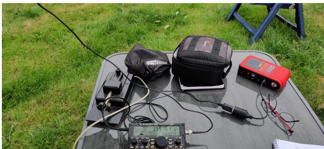
OZ1JFK's Qrp portabel opsætning – station og parasolantenne..
