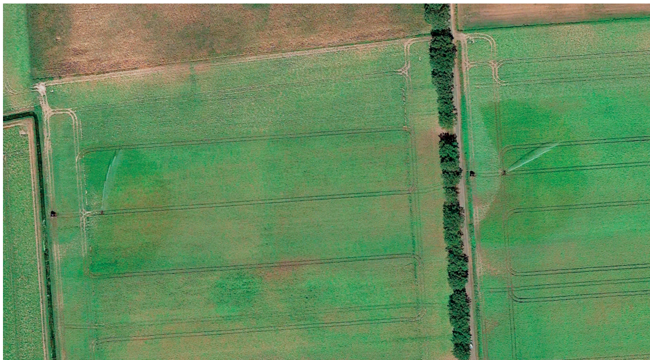
Afbeelding 5. Vanuit een satelliet gezien zijn hier, in het oosten van provincie Noord-Brabant, twee beregeninginstallaties in werking. Met nieuwe technieken van beeldherkenning zijn daarvan de sproeiers en de haspels automatisch op te sporen.
