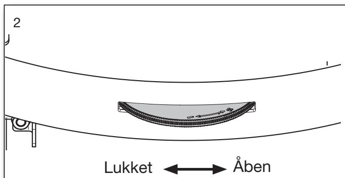
Der åbnes helt for forbrændingsluften, og evt. for opstartsluften. Når ilden har godt fat, og skorstenen er blevet varm lukkes opstartsluften. Det anbefales at hele den første indfyring afbrændes med forbrændingsluften helt åben, således at ovn og skorsten bliver godt gennemvarmed.
