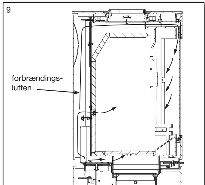
Min. skorstenstræk er: 11 PA. Det er ved dette træk, at ovnen er afprøvet og godkendt, og det er nødvendigt for at give en ren forbrænding med et flot flammebillede samt høj virkningsgrad og dermed en god brændeøkonomi.
