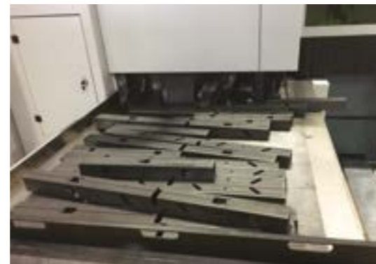
Das automatische Fördersystem übernimmt jedes Rohr und Profil bis zu 6 m Länge und führt es nach draußen.
