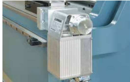
Bombierungssystem mit CNC-Steuerung
