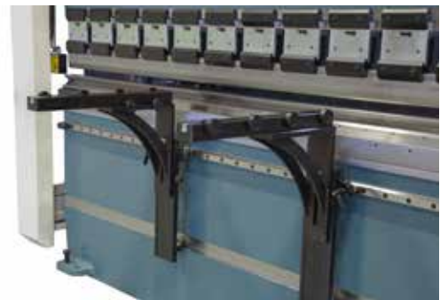
Vorderes Stützsystem für Bleche, mit Linearführung
