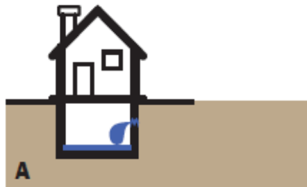
A Vand ind gennem revner el.lign. i kældervæg, gulv
