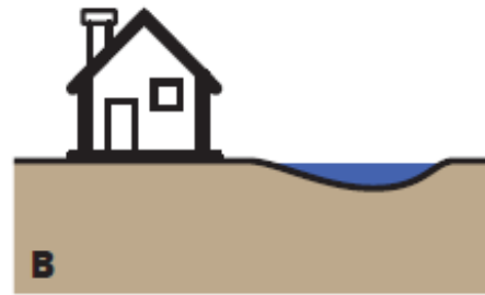
B Vand stående i lavpunkt på grund
