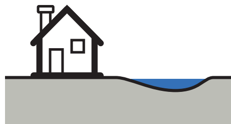
Vand stående i lavpunkt på grund
