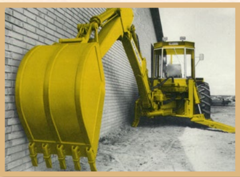
I 1975 udvikler Hydrema den hydrauliske sideforskydning på graveren. Den første model med denne løsning var 56F4, som blev bygget på en Ford 4550. I produktion: 1975 – 1980.
