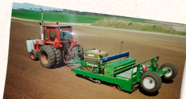
Albert Hedegaard Borbjerg Maskinstation - ca. 1990: Volvo 2650 med Kyndestoft Combi-pak 4000 her monteret med 2 slags flydende gødning for placering samt gummihjulsjordpækker, harve tænder, rørpakkevalse, kornsåmaskine, græsfrøåkasse samt pakkevalse og til sidst brede specialaflastningshjul, så der kunne korrigeres for hhv. tørre og fugtige forhold.
