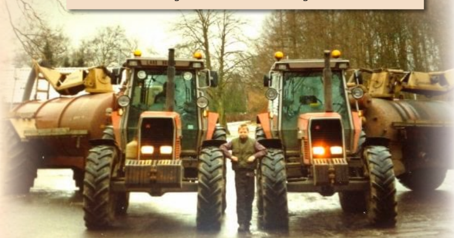
Albert Hedegaard Borbjerg Maskinstation - ca. 1990: Volvo 2650 med Kyndestoft Combi-pak 4000 her monteret med 2 slags flydende gødning for placering samt gummihjulsjordpækker, harve tænder, rørpakkevalse, kornsåmaskine, græsfrøåkasse samt pakkevalse og til sidst brede specialaflastningshjul, så der kunne korrigeres for hhv. tørre og fugtige forhold.
