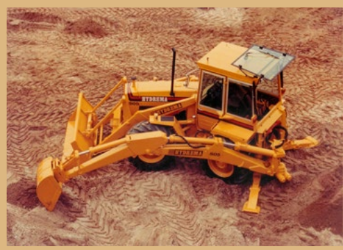
I 1980 begynder Hydrema at bygge maskiner helt fra bunden. Model 805/807 blev bygget på et knækstyret genproduceret chassis. Den var udstyret med Hydrema's patenterede hydrauliske sideforskydning på graveren. I produktion: 1980 – 1989
