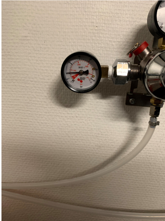
Figur 1.4. Dette manometer skal være helt i bund, i det røde felt, før du må skifte kulcyreflasken.
