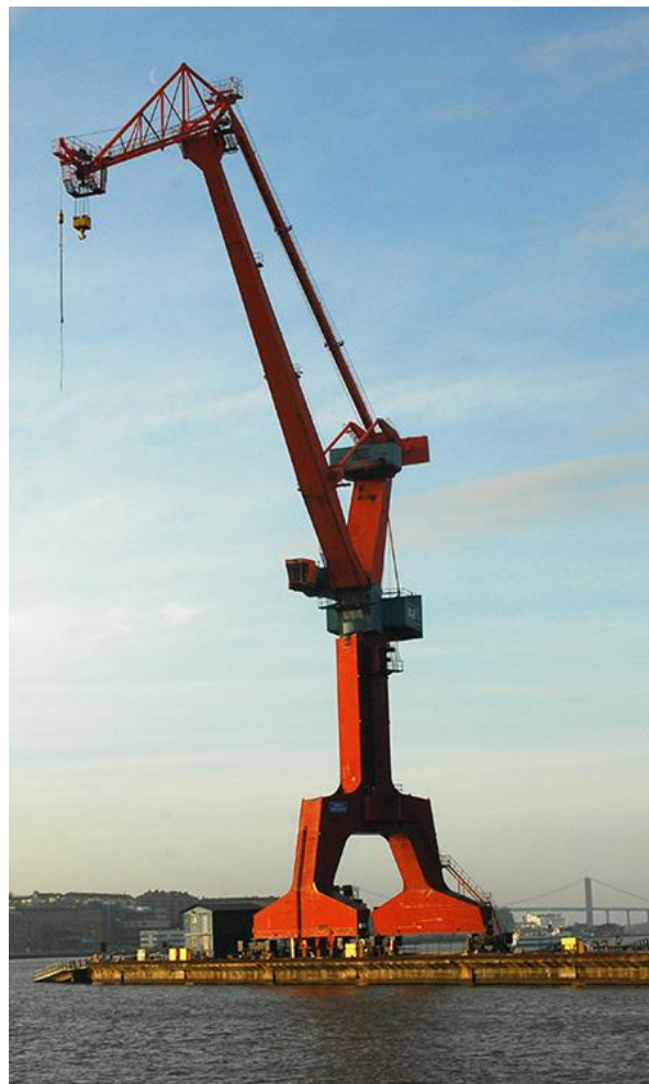
Ovan t.v. En äldre portalsvängkran (22) med vipparm som står vid Broströmskajen. Kranen är av en nitad fackverkskonstruktion. Ovan t.h. En portalsvängkran (23) med vipparm, troligen en Kone från 1974. Kranen är svetsad. Foto Lena Knutson Udd 2016.
