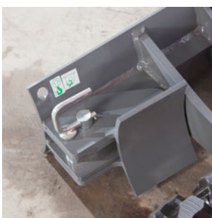
Dozerblad handmatig te verbreden
