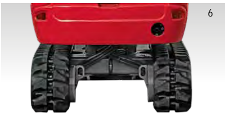
BREEDTE INGESCHOVEN ONDERWAGEN 980 MM
