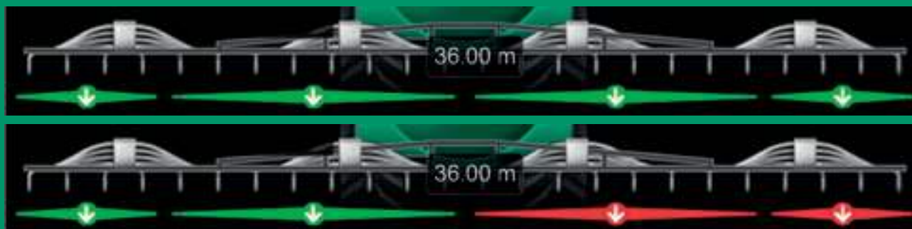
Der kan laves sektionsafblænding ved hver fordeler. Når sektioner afblændes, tilpasses gyllemængden, så doseringen holdes konstant.
