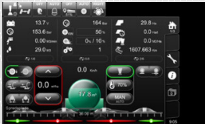
Det er meget nemt at betjene den nye bom via SlurryMaster 8000 styresystemet. Man kan altid se, hvilke fordelere, der er i brug.
