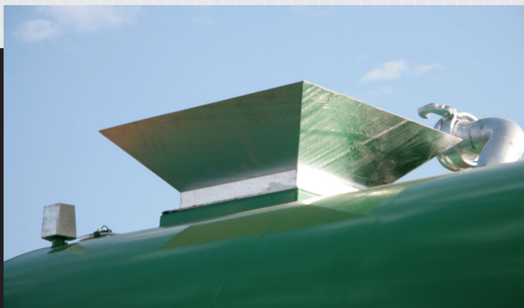
Ekstern fyldning via fyldetragt
