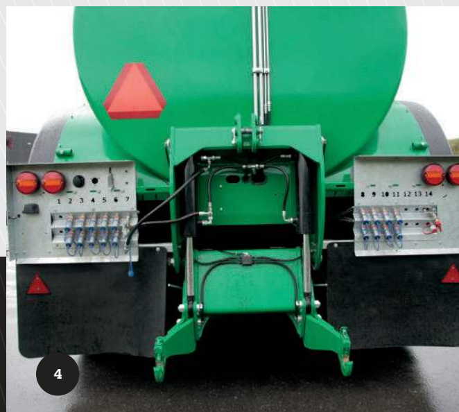
Hydraulikkoblingerne er placeret, så der er nem adgang.
