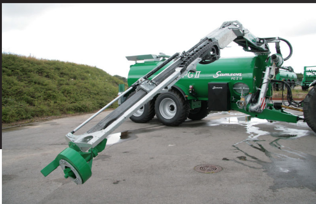
Pumpetårn med teleskoparm.
